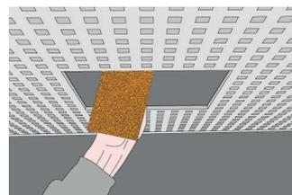
A continuación, biselar levemente con un cuchillo la cara vista del panel de diseño acústico, para simplificar el enmasillado posterior. Posteriormente, colocar el bastidor de la tapa de revisión y fijarlo con una ayuda de montaje que se adapte al diseño de orificios.
